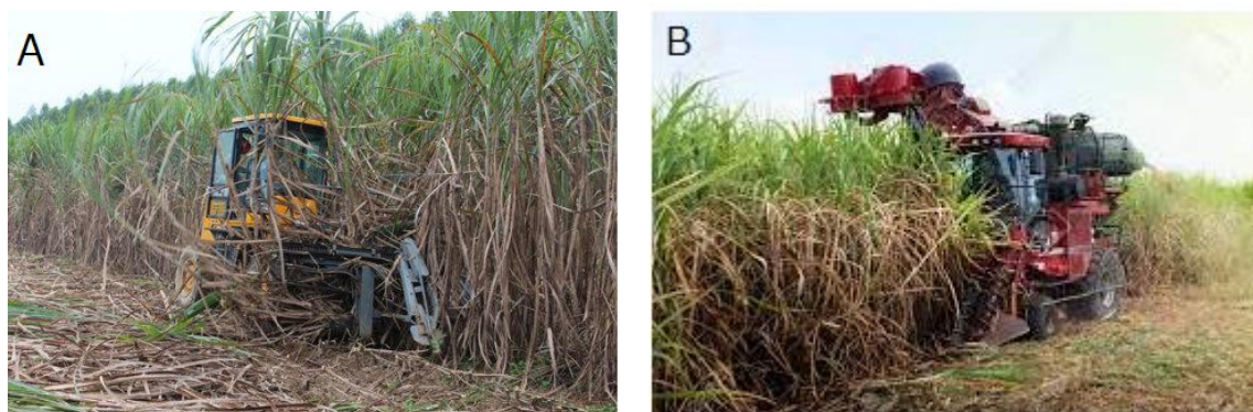
図 7. サトウキビの機械収穫 (A: 全茎式収穫機 (刈取機)、B: 裁断式収穫機 (ハーベスタ))
