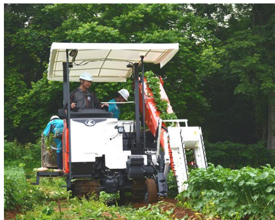
図 9. ダイコンの機械収穫
