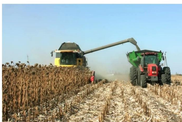
図 6. 専用コンバインによるヒマワリの機械収穫 (Shutterstock.com より引用)
