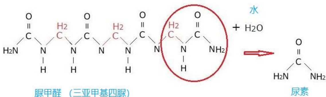
图 2. 脲甲醛的加水分解模式图
