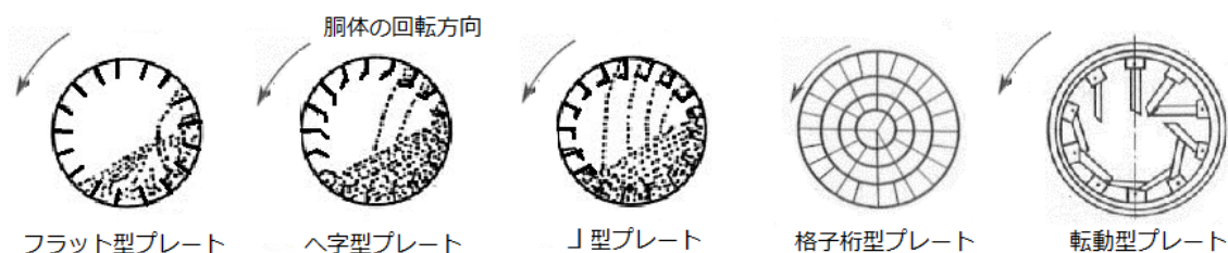
図 14. ロータリーキルンによく使われる攪拌プレートの形状
