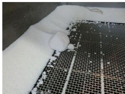
図 7. BB 肥料混合装置原料ホッパーの篩
